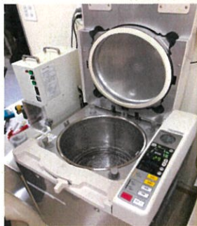
新規導入された レトルト製造釜
